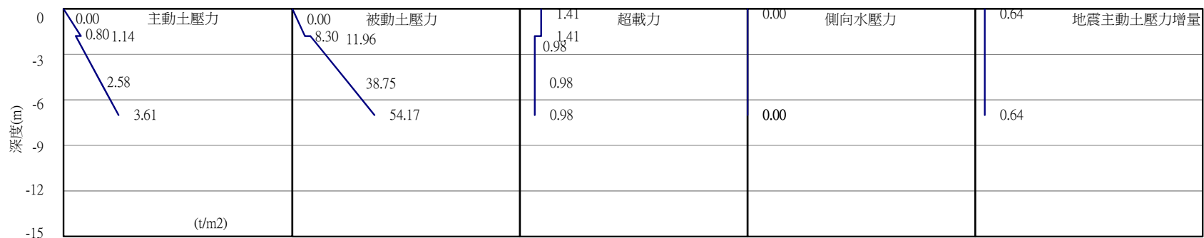
圖 6-6 臨時土壓力及水壓力
